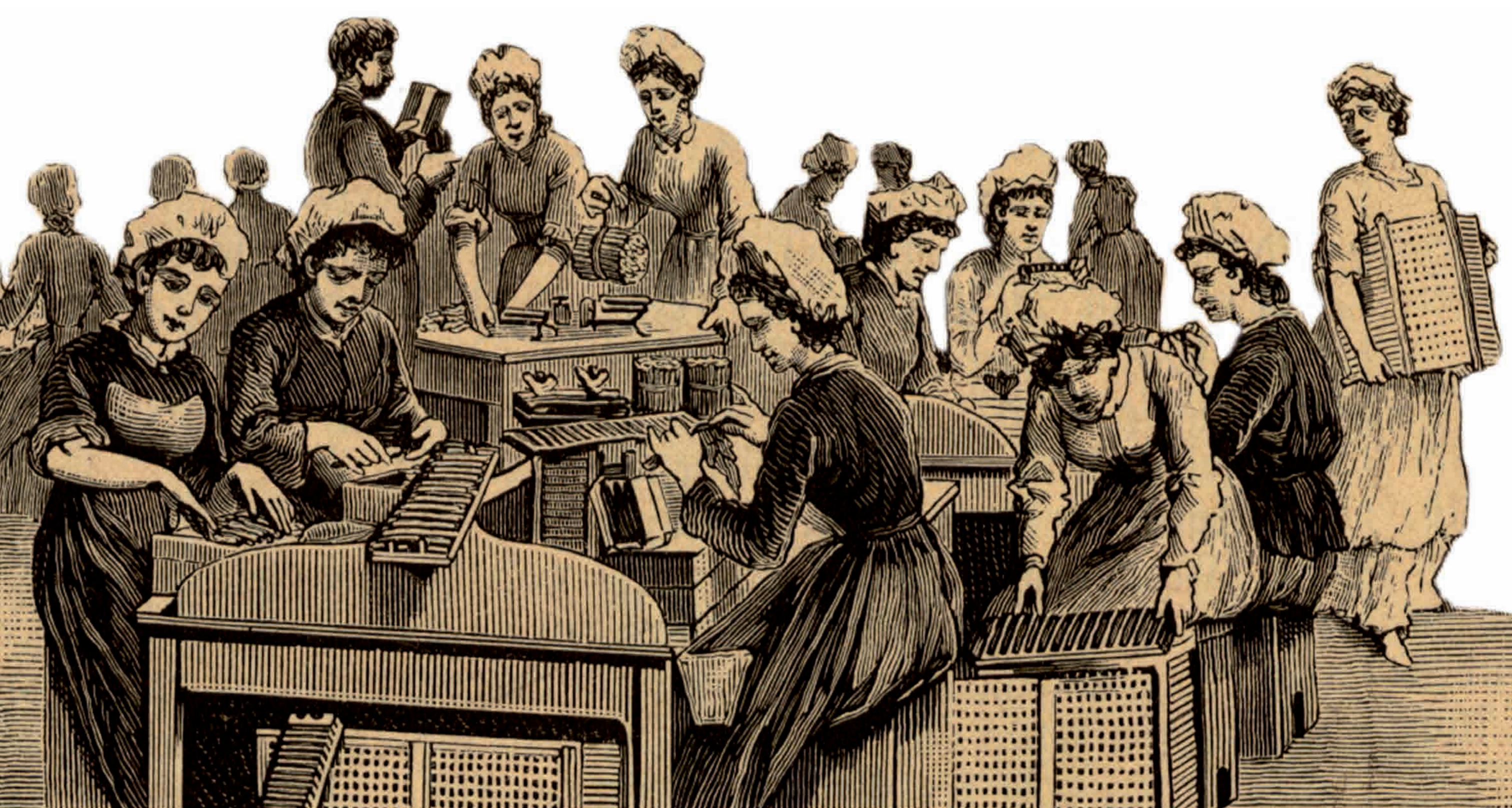
Blick in eine Tabakfabrik um 1880: Der Tabak wird zu Zigarren gerollt und diese werden sortiert und verpackt. Zeitgenössischer Stich 1884.
